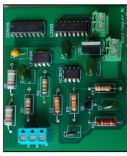
Fig: Analog Single-Magnet PCB
